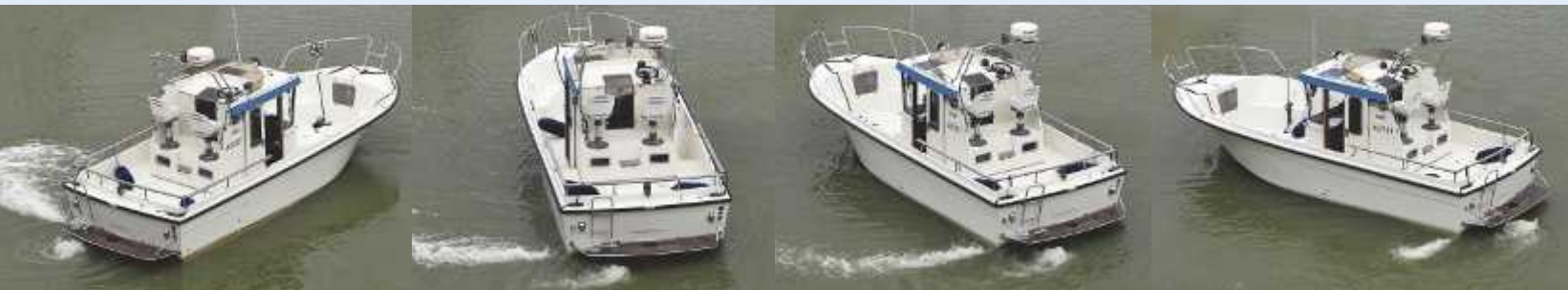
Vastakkaisia suulakkeita käyttämällä vene kääntyy paikallaan, joskin hitaasti. Parhaimmillaan laitteisto on kuitenkin apuvoimina täydentämässä veneen omaa vetojärjestelmää ahtaissa satamissa.
