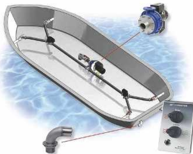
Jet-Thrusterin asennusmahdollisuudet ovat joustavat, koska pumppu voidaan sijoittaa vapaasti vesilinjan alapuolella ja ulostulosuulakkeet letkuineen mahtuvat kulkemaan ahtaissakin tiloissa.
